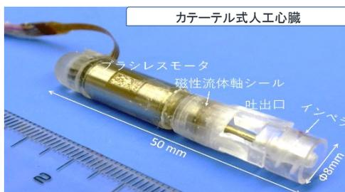
**カテーテル設置式超小型補助人工心臓の試作モデルver.1**。現在設計中のモデルver.3は、外径6.4mm×長さ40mmとなり、大腿動脈からの挿入が可能になる。
