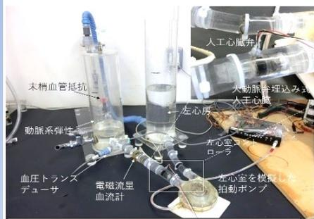
左心房、左心室、末梢血管抵抗、動脈系コンプライアンスで構成する生体血液循環模擬回路を使い、開発した人工心臓の性能評価を行います。左心室をモータ駆動人工心臓で模擬しているのが特徴です。
